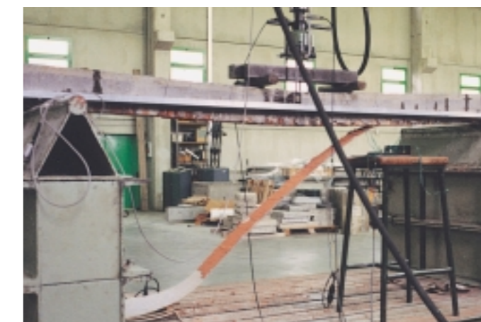
Rottura per peeling del travetto TR\1G.
