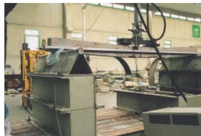
Rottura a trazione della fibra di carbonio per il travetto TR\1C.
