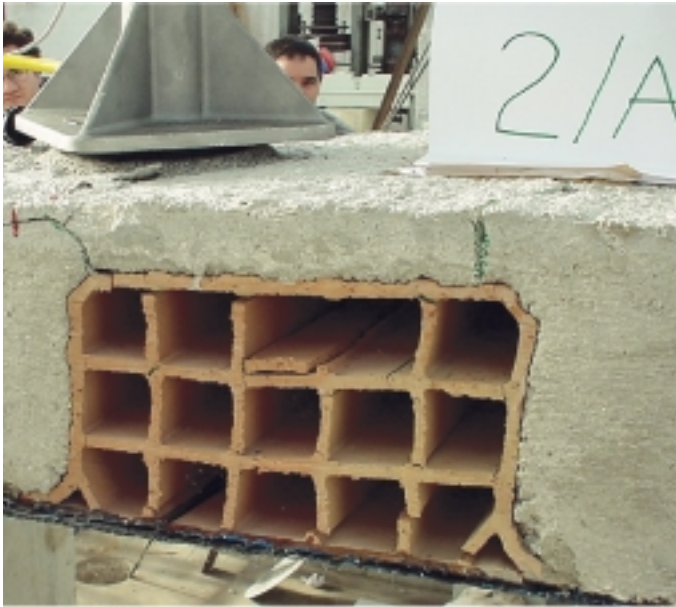
Campione tipo 2: collasso del provino.
