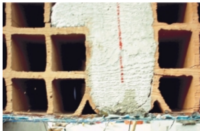
Campione tipo 1: collasso del provino con rottura dei blocchi e della parte terminale dalla nervatura.
