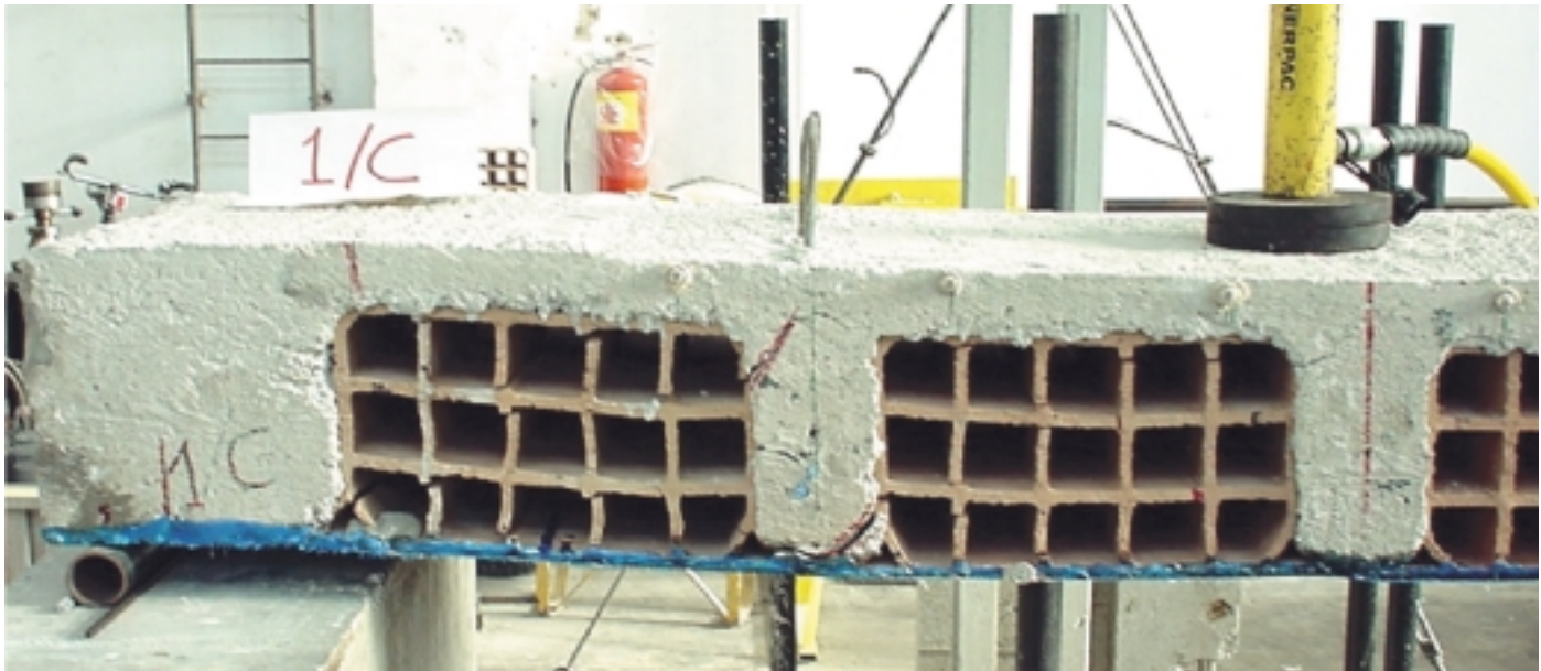
Campione tipo 1 portato al collasso.
