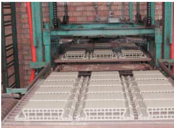
Fig. 3 - Fase produttiva del blocco. Si nota l'aletta che funge da suola per il travetto. Production of the block. It is possible to note the wing that acts as a base for the beams.
