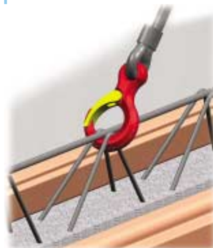
Fig. 11 - È possibile agganciare direttamente il traliccio metallico. It is possible to hook directly to the wire netting.
