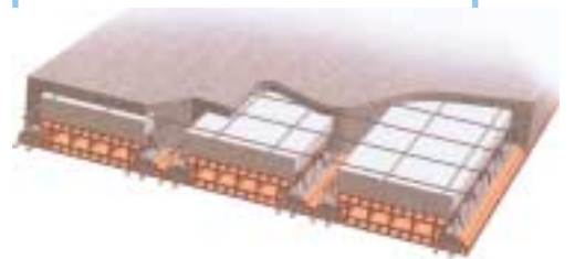
Fig. 1 - Schema di solaio realizzato con pannelli IN.PR.E. Diagram of the floor built in IN.PR.E. panels.
