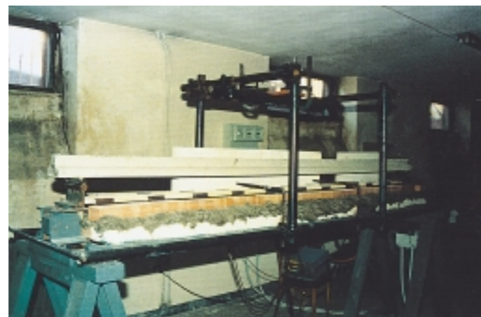
Travetto precompresso e struttura di sostegno.
