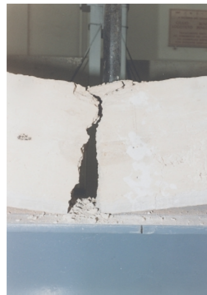
Particolare della rottura di un travetto della seconda serie dovuta al cedimento delle tracce di precompressione.
