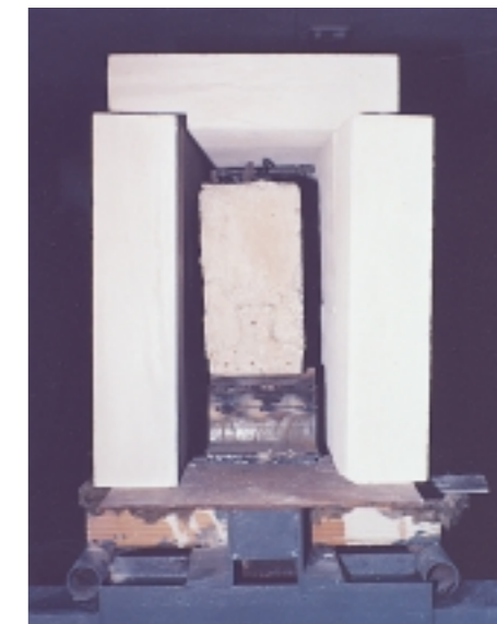
Seconda serie di prove: posizionamento della trave (travetto + getto di completamento) all'interno del forno.
